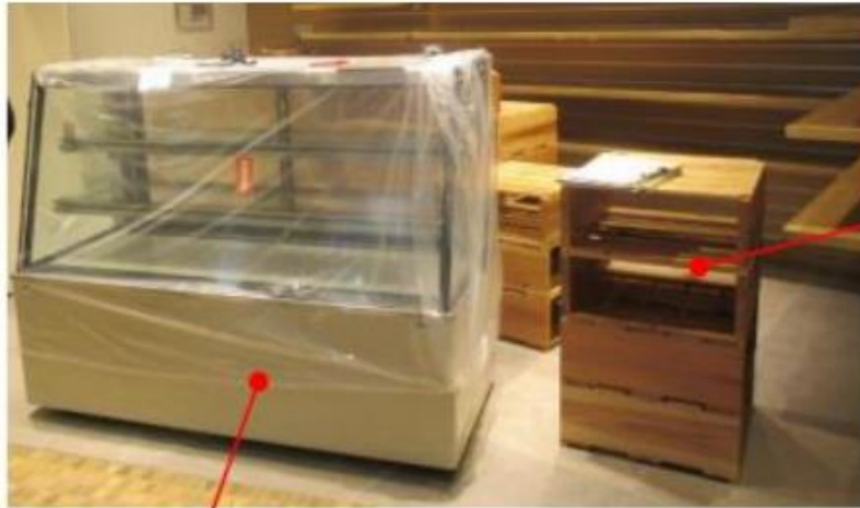
■ 冷蔵ショーケース 外形サイズ (W1500×D652×H1155mm) 内形サイズ (W1325×D406×H616mm)
